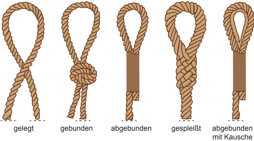
Abb. 6: Varianten des Augendes einer Leine
