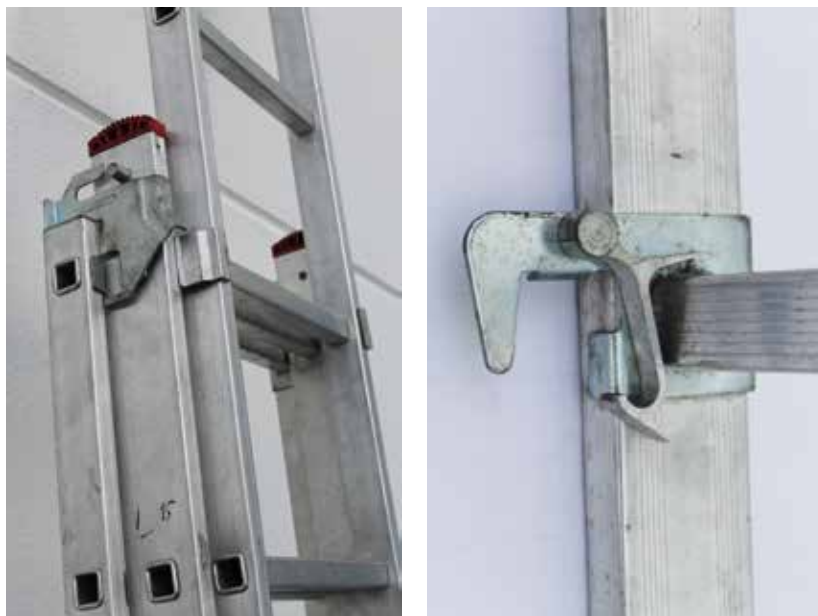
Abb. 37: Kombinationsleiter, Kopfende und Sicherungsbügel
