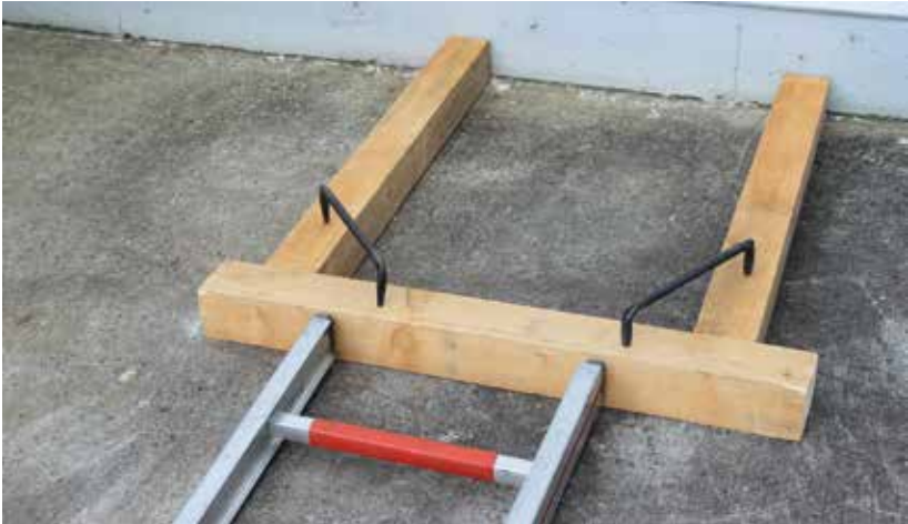
Abb. 14: Aufrichten über Widerlager
