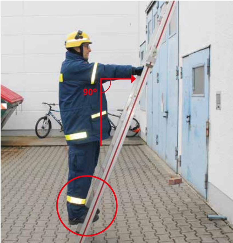
Abb. 17: Prüfen des Anstellwinkels mit Arm
